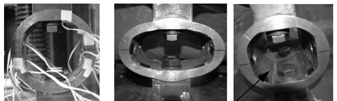
写真6 試験前後の接合部ノード(S100C) 写真7 圧縮試験体 D200C 亀裂
