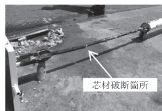
写真 2 芯材破断(A0E0-S)
